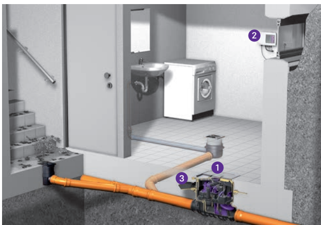
1 Насосная станция обратного подпора 2 Блок управления 3 Комплект уплотнений
