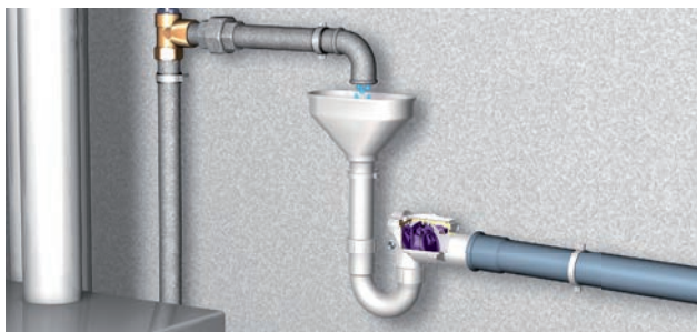
Умывальники с канализационным сифоном и подключением стиральной машин
