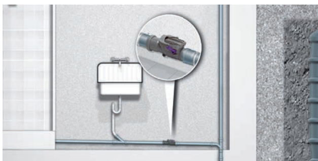
Открыто проложенная сливная труба Ø 50 ili Ø 75
