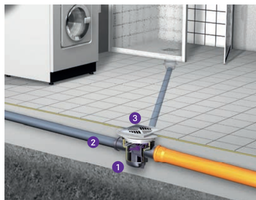
1 Трап 2 Подводящая труба 3 Стальная крышка
