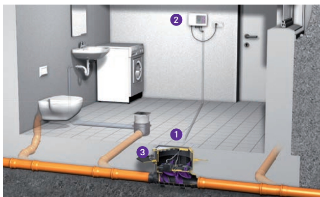
1 Обратный клапан 2 Блок управления 3 Комплект уплотнений
