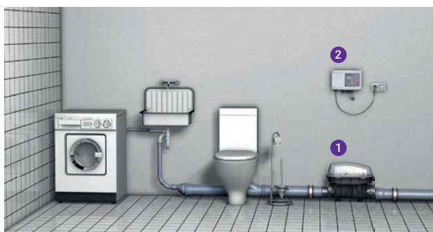
1 Обратный клапан 2 Блок управления
