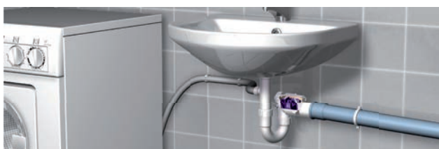
Умывальники с канализационным сифоном и подключением стиральной машин
