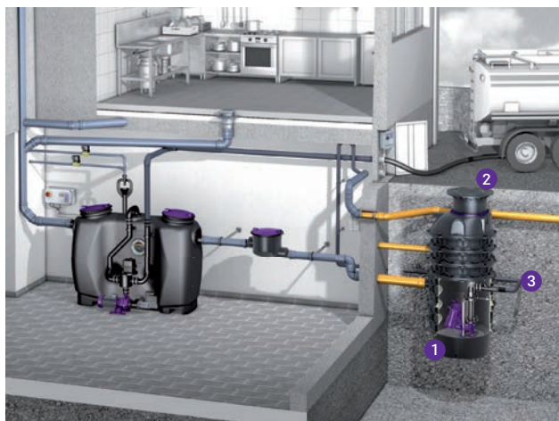
1 Насосная станция 2 Шахта колодца 3 Напорный трубопровод
