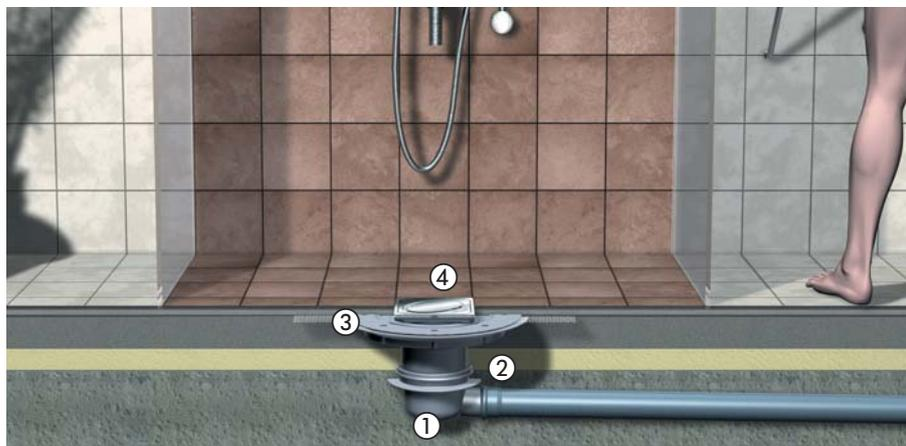
Трап для ванных комнат Classic ① представляет собой компактный трап и доступен во многих вариантах. Он доступен с вертикальным и горизонтальным отводом ② в размерах Ø 50 и Ø мм и широким ассортиментом опционально доступных фланцев ③ для гидроизоляции. Декоративная решетка из нержавеющей стали Oval ④ - может быть заменена на любую другую декоративную решетку системы 100.
